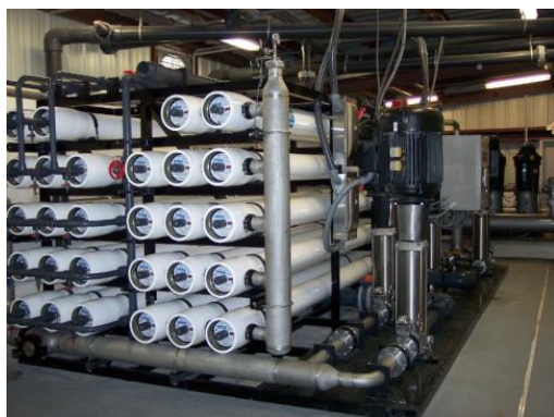
图3-反渗透膜和过滤器均遭受溢油污染事件的影响
