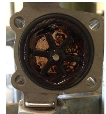
安装的仪器和碳氢化合物污染对膜造成的破坏。
